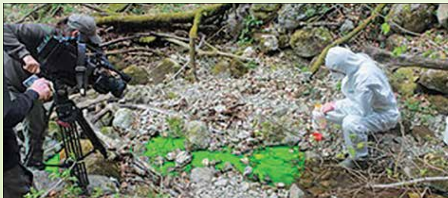
Injiciranje fluorescentnega sledila uranin v ponikajočo Suho, ki je bilo opravljeno v sklopu snemanja oddaje Ugriznimo znanost (Foto: N. Ravbar).
