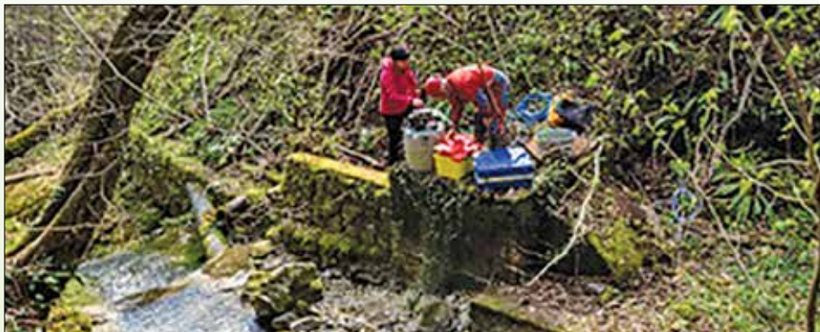
Namestitev raziskovalne opreme za avtomatsko vzorčenje vode na Žegnanem studencu (Foto: M. Blatnik).
